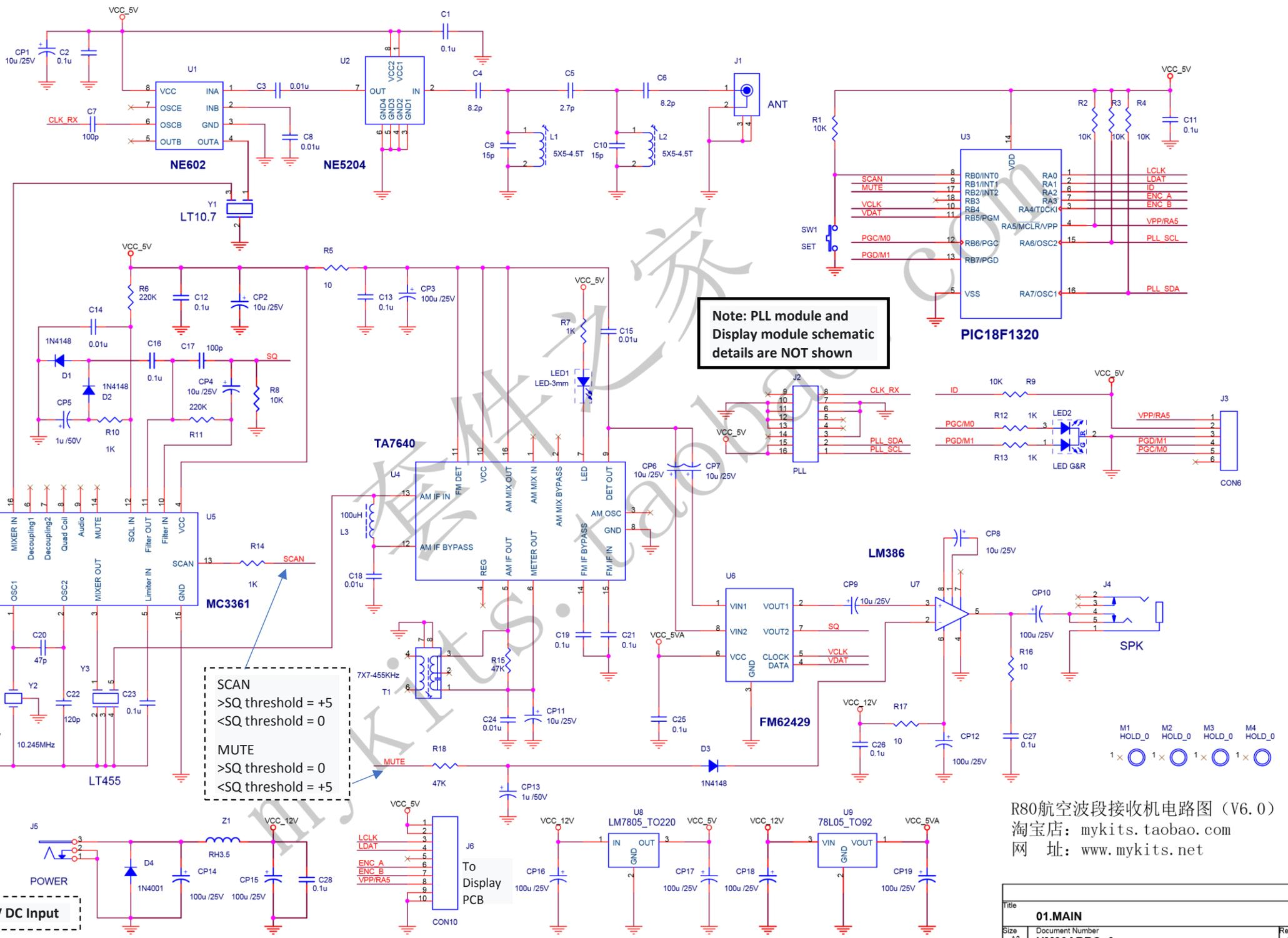
R80航空波段接收机电路图 (V6.0)
